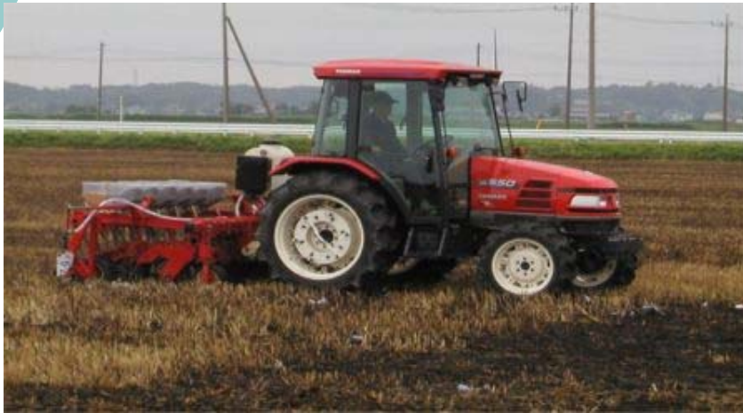
汎用型不耕起播種機(市販機)による営農組合の大豆不耕起播種作業
