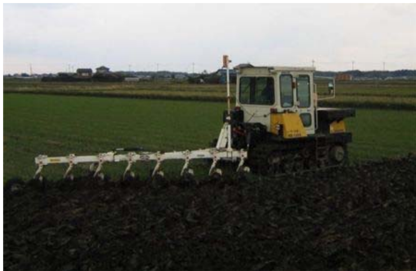
レーザーレベラーによる均平作業
