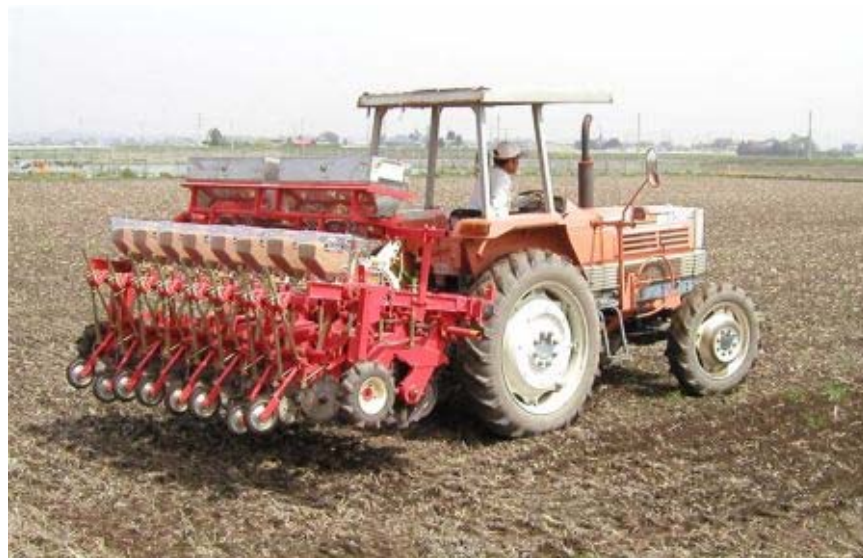
開発したディスク駆動式汎用型不耕起播種期
